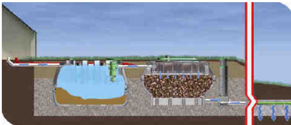
Figure 1 : Filière "Filtre à coco" EPURFIX ®
