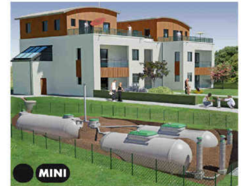
Filière compacte coco EPURFLO® MINI pour 20 EH (fosse septique, répartiteur 2 Voies et 2 filtres MINI en parallèle)
